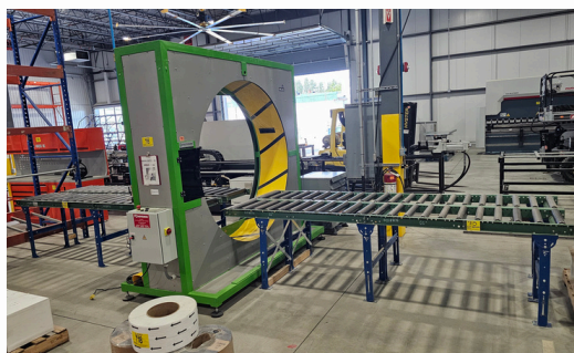
EMBALLEUSE SEMI-ORBITALE PLASTICBAND, 600 V, 2022, MOD. NELEO 200, SÉRIE 5002, AVEC CONVOYEUR DOUBLE, TOTAL 4 UNITÉS DE CONVOYEURS 11' CHAQUE, AVEC ROULEAUX DE WRAPPING ± 24 ROULEAUX
