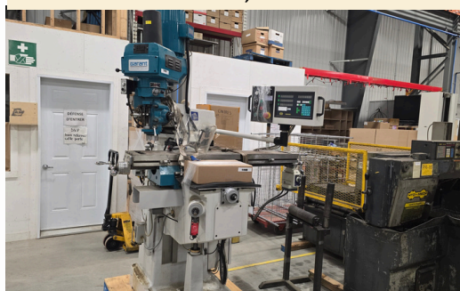
FRAISEUSE ELITE, CONTRÔLE SW4000, TALBE 10'' X 54'', FEEDER ELECTRIQUE
