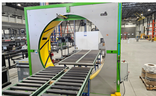
EMBALLEUSE SEMI-ORBITALE PLASTICBAND, 600 V, 2022, MOD. NELEO 200, SÉRIE 5002, AVEC CONVOYEUR DOUBLE, TOTAL 4 UNITÉS DE CONVOYEURS 11' CHAQUE, AVEC ROULEAUX DE WRAPPING ± 24 ROULEAUX
