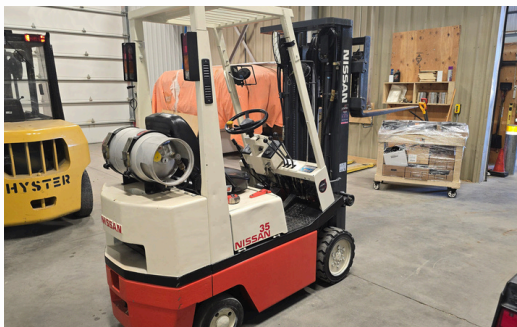
CHARIOT ÉLÉVATEUR NISSAN, MODÈLE 35, PNEUS DURS, PROPANE, 9613 H, CAPACITÉ 4800 LB, ÉLEVATION 187"
