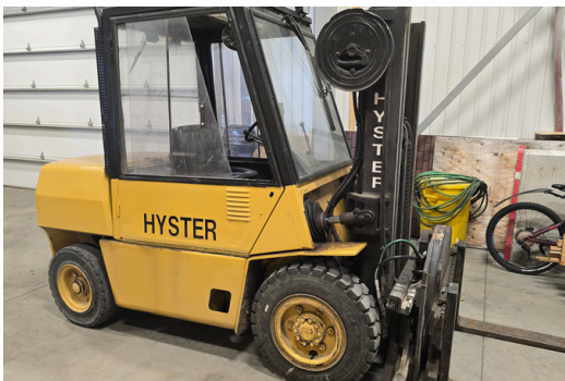
CHARIOT ÉLÉVATEUR HYSTER DIESEL, AVEC SYSTEME DE ROTARY 360, CAPACITÉ 7200 LB, 8047 H, ÉLEVATION 121"
