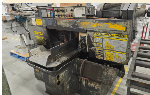
SCIE À MÉTAL HYD-MECH H-12, 2018, ÉTAU HYDRAULIQUE, CONTRÔLE PLC 100
