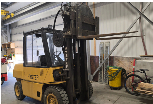
CHARIOT ÉLÉVATEUR HYSTER DIESEL, AVEC SYSTEME DE ROTARY 360, CAPACITÉ 7200 LB, 8047 H, ÉLEVATION 121"
