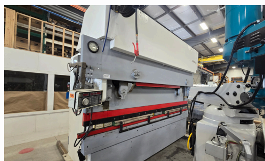
PRESSE PLIEUSE DURMA HYDRAULIQUE 12', SÉCURISÉE AVEC CONTRÔLE NUMÉRIQUE COMP-U-BEND 610, BACK GAUGE, INCLUANT BOÎTE DE POINÇONS SUPPLÉMENTAIRES ET (2) MATRICES POUR PRESSE PLIEUSE DE 10'
