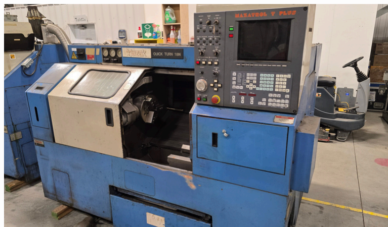
TOUR CNC MAZAK QUICK TURN 18 N, CONTRÔLE MAZATROL T PLUS, SÉRIE 113860, 1995, CONVOYEUR À COPEAUX JORGENSEN
