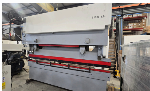
PRESSE PLIEUSE DURMA HYDRAULIQUE 12', SÉCURISÉE AVEC CONTRÔLE NUMÉRIQUE COMP-U-BEND 610, BACK GAUGE, INCLUANT BOÎTE DE POINÇONS SUPPLÉMENTAIRES ET (2) MATRICES POUR PRESSE PLIEUSE DE 10'
