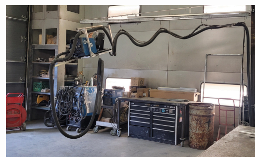
SOUDEUSE MILLER, MODÈLE SHOPMATE 300 DX, ALIMENTEUR À FIL MILLER MOD. 20 SERIES, AVEC POLE JIB
