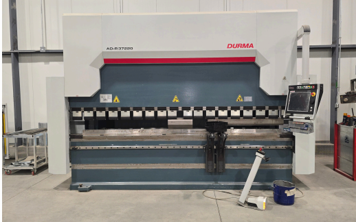
PRESSE PLIEUSE CNC DURMA, 2020, MODÈLE AD-R 37220, CAP. 3700 X 220 TONNES, AVEC CONTRÔLE NUMÉRIQUE DURMA MODÈLE DA-66T
