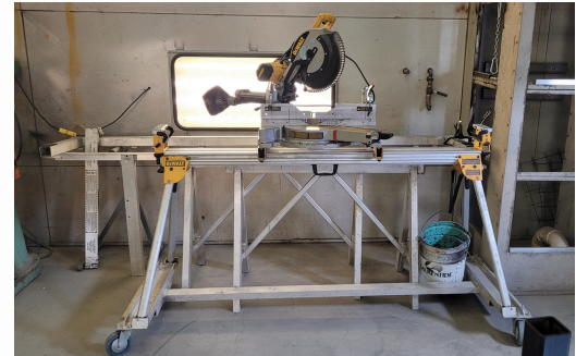
SCIE À ONGLET DEWALT, DWS780 SUR BASE AVEC GUIDES
