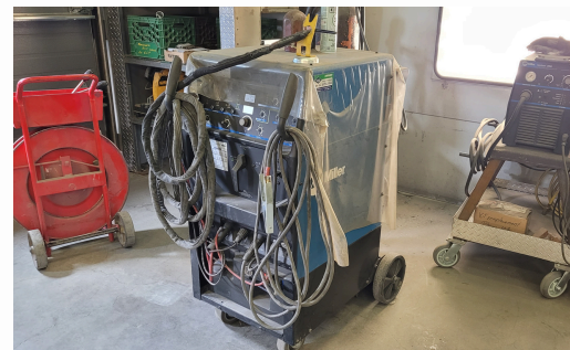
SOUDEUSE TIG, MILLER, MODÈLE SYNCROWAVE 250DX
