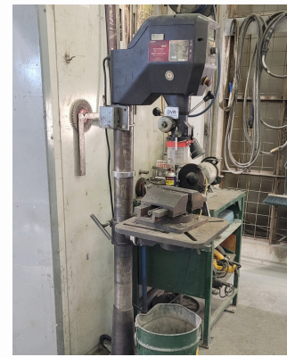
PERCEUSE À COLONNE 18'', MODÈLE NOVA VOYAGER DVR 6'' STROKE TRANSMISSION DIRECT CHUCK 5/8
