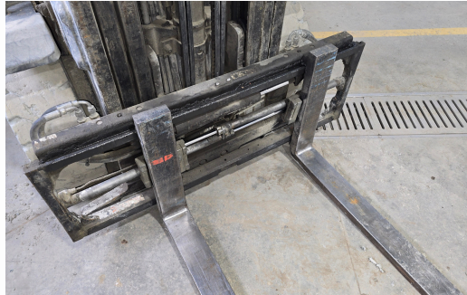
CHARIOT ÉLEVATEUR HYSTER H50FT, PROPANE, PNEUMATIQUE, CAP. 4 800 LB, MAT 3 SECTIONS, POSITIONNEUR DE FOURCHES
