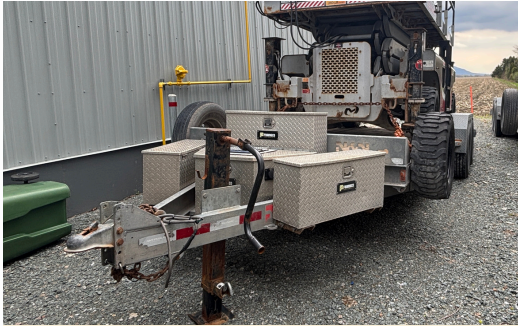
REMORQUE N&N PLATEFORME BASCULANTE, MOD. TD20G, 2021, 20', GALVANISÉ, 2 ESSIEUX (SYSTÈME DE BASCULE HYDRAULIQUE, TREUIL ÉLECTRIQUE)
