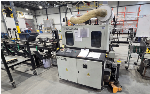
SCIE CIRCULAIRE CNC BEKAMAK, 2020, MODÈLE BMDO 80 CS, DÉPOUSSIÉREUR FILTREOMAX MOD. FO-800 AVEC ENSEMBLE DE TABLE ALIMENTEUR DE TUYAUX ET TABLE DE SORTIE
