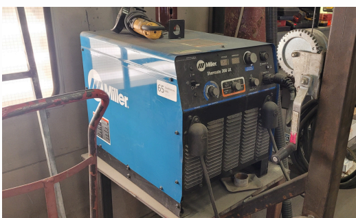
SOUDEUSE MILLER, MODÈLE SHOPMATE 300 DX, ALIMENTEUR À FIL MILLER MOD. 20 SERIES, AVEC POLE JIB
