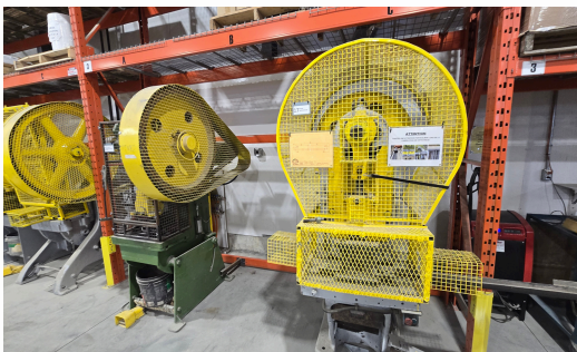
PLUS DE 6 UNITÉS DE PRESSES POINÇONNEUSES (PUNCH PRESS), MARQUE : SOENEN, ALCECO, BLISS, ET AUTRES
