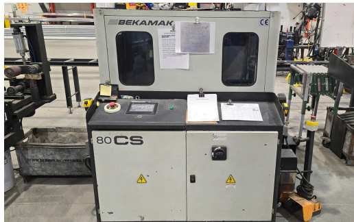
SCIE CIRCULAIRE CNC BEKAMAK, 2020, MODÈLE BMDO 80 CS, DÉPOUSSIÉREUR FILTREOMAX MOD. FO-800 AVEC ENSEMBLE DE TABLE ALIMENTEUR DE TUYAUX ET TABLE DE SORTIE
