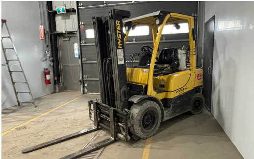
CHARIOT ÉLEVATEUR HYSTER H50FT, PROPANE, PNEUMATIQUE, CAP. 4 800 LB, MAT 3 SECTIONS, POSITIONNEUR DE FOURCHES
