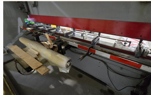
PRESSE PLIEUSE HYDRAULIQUE DURMA 12', CONTRÔLE COMP-U-BEND 610
