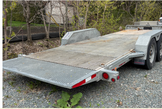
REMORQUE N&N PLATEFORME BASCULANTE, MOD. TD20G, 2021, 20', GALVANISÉ, 2 ESSIEUX (SYSTÈME DE BASCULE HYDRAULIQUE, TREUIL ÉLECTRIQUE)
