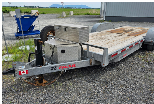
REMORQUE K-TRAIL, MODÈLE DECK SERIES, 2017, PLATEFORME BASCULANTE, PNBV 4479 KG, 2 ESSIEUX 2240 KG CHACUN
