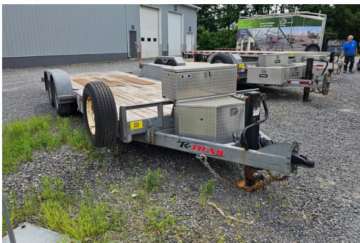
REMORQUE K-TRAIL, MODÈLE DECK SERIES, 2017, PLATEFORME BASCULANTE, PNBV 4479 KG, 2 ESSIEUX 2240 KG CHACUN
