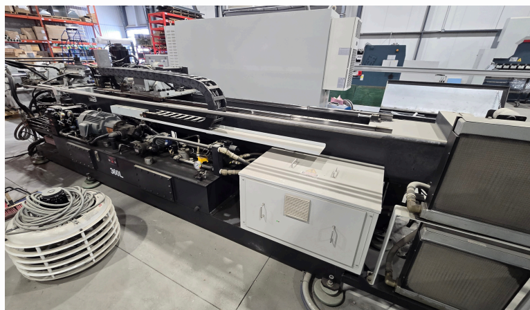
PLIEUSE À TUYAUX (PIPE BENDER) CINTREUSE UTE SELECT, MODÈLE US80ED4A 5/8 À 6", 4 AXES
