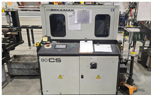
SCIE CIRCULAIRE CNC BEKAMAK, 2020, MODÈLE BMD0 80 CS, DÉPOUSSIÈREUR FILTREOMAX MOD. FO-800 AVEC ENSEMBLE DE TABLE ALIMENTEUR DE TUYAUX ET TABLE DE SORTIE
