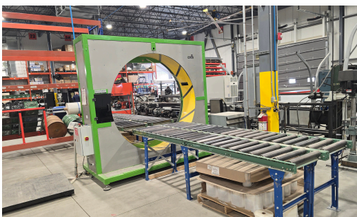
EMBALLEUSE SEM-ORBITALE PLASTICBAND, 2022, MODÈLE NELEO 200 AVEC CONVOYEURS À ROULEAU 66"
