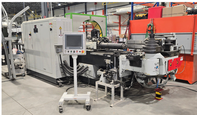
PLIEUSE À TUYAUX (PIPE BENDER) CINTREUSE UTE SELECT, MODÈLE US80ED4A 5/8 À 6", 4 AXES
