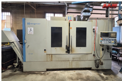
CNC CENTRE D'USINAGE BRIGEPORT, GX1600, CONTRÔLE FANUC OI-MD, 2011, AVEC CONVOYEUR À COPEAUX
