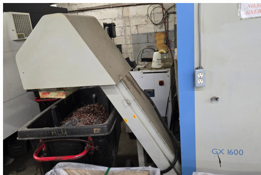
CNC CENTRE D'USINAGE BRIGEPORT, GX1600, CONTRÔLE FANUC OI-MD, 2011, AVEC CONVOYEUR À COPEAUX
