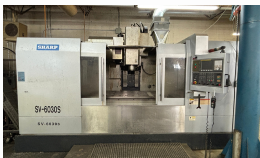
CNC CENTRE D'USINAGE SHARP, SV 6030S, CONTRÔLE FANUC OI-MP, 2010, AVEC CONVOYEUR À COPEAUX
