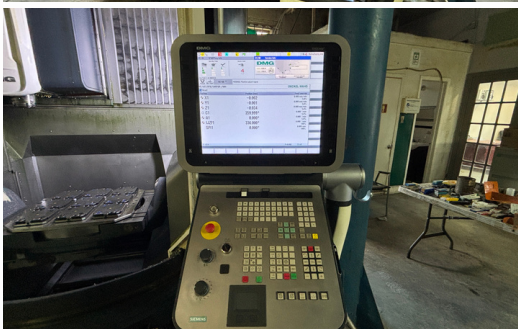
CENTRE D'USINAGE UNIVERSEL 5 AXES, DMG MORI, DMU 65 MONO BLOCK 3D CONTRÔLE SIEMENS 840D, SPINDLE CARTBRIGE 18000 RPM, HSK63, 60 OUTILS, INSTALLÉ EN 2023
