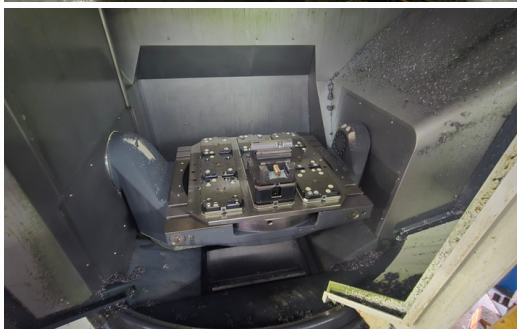
CENTRE D'USINAGE UNIVERSEL 5 AXES, DMG MORI, DMU 65 MONO BLOCK 3D CONTRÔLE SIEMENS 840D, SPINDLE CARTBRIGE 18000 RPM, HSK63, 60 OUTILS, INSTALLÉ EN 2023
