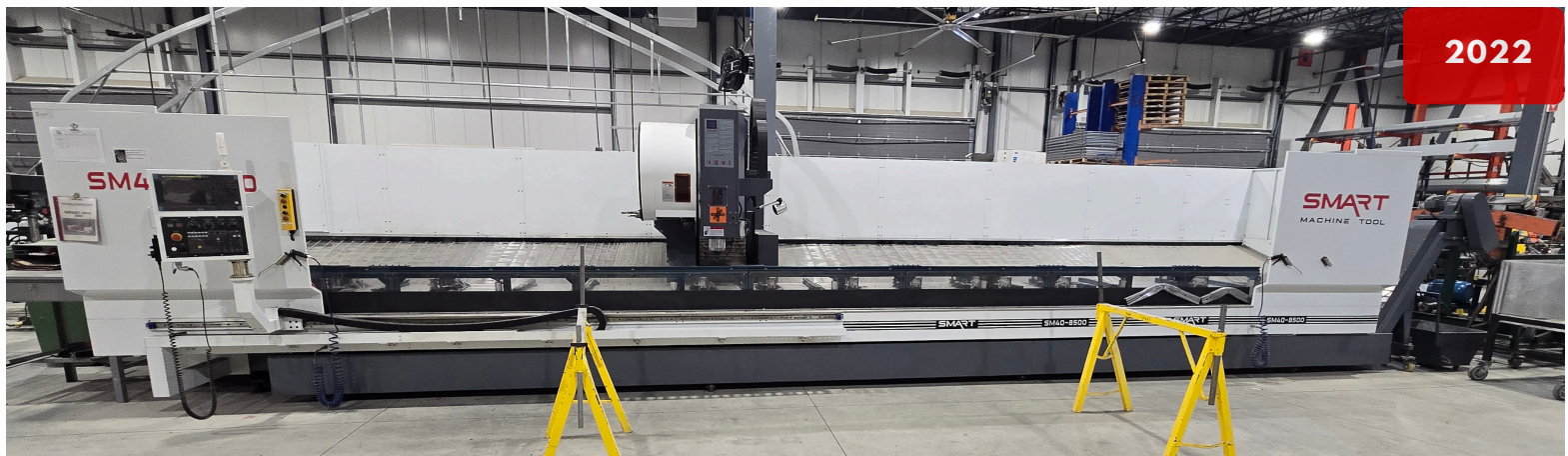
CENTRE D'USINAGE SMART SM40-8500, 4 AXES (CENTRE DE PERÇAGE ET TARAUDAGE) 30 OUTILS AVEC CONTRÔLE FANUC PRATIC
