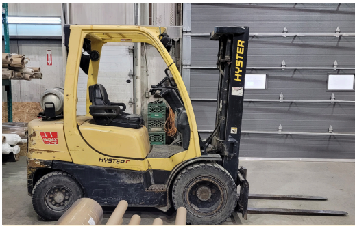
CHARIOT ÉLEVATEUR HYSTER H50FT, PROPANE, PNEUMATIQUE, CAP. 4 800 LB, 6838 HEURES, ÉLEVATION 171.3"
