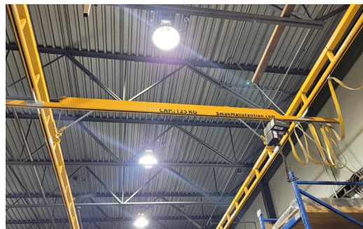
PONT ROULANT SMAK MANUTENTION AVEC 2 PALANS CAP. 125 KG
