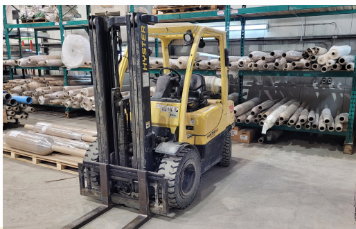
CHARIOT ÉLEVATEUR HYSTER H50FT, PROPANE, PNEUMATIQUE, CAP. 4 800 LB, 6838 HEURES, ÉLEVATION 171.3"
