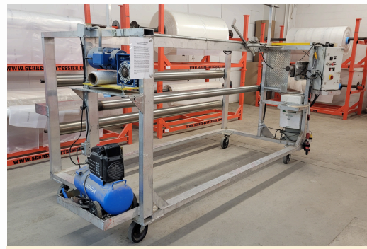
DÉROULEUR MOBILE POUR TOILES DE POLYTHÈNE AVEC COMPTEUR ET COMPRESSEUR MASTERCRAFT
