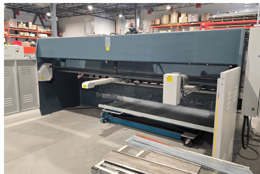
CISAILLE CNC DURMA, MODÈLE SBT 4006, ANNÉE 2021, AVEC CONTRÔLE DT-7 NUMÉRIQUE, BACK GAUGE SECURISÉ, CAPACITÉ 4100 X 6 MM
