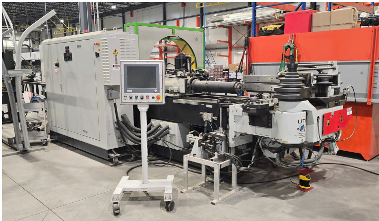
PLIEUSE À TUYAUX (PIPE BENDER) CINTREUSE UTE SELECT, MODÈLE US80ED4A 5/8 À 3", 4 AXES
