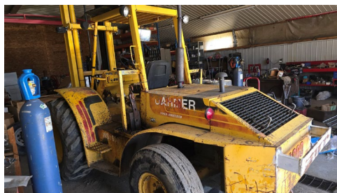
Chariot élévateur diesel Dahmer side shift, modèle WS1602F8, capacité 8 000 livres
