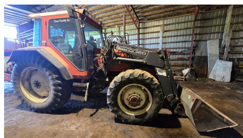
Tracteur Fiat Agri F-110DT avec chargeur frontal Quicke 560
