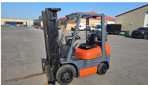
Chariot élévateur propane Toyota, 3500 lb, mât 3 sections, pneus durs
