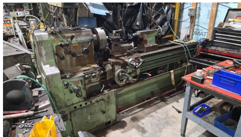
Tour Yam – 1500 HG avec read out Mitutoyo, 2 axes, swing bed
