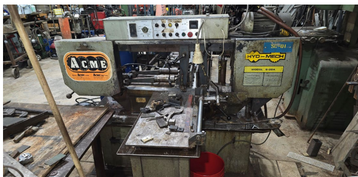
Scie à ruban horizontale Hyd-Mech, mod. S-20A avec étau hydraulique, convoyeur à rouleaux
