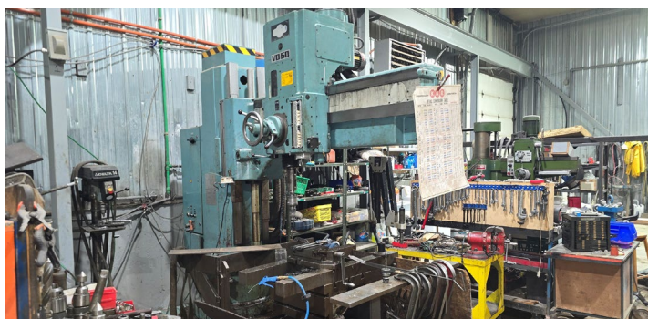
Perceuse radiale MAS V050, cap. 50 MM, portée de 1100 MM, vitesse 28 à 2500 tr / min.
