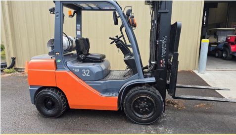
Chariot élévateur Toyota 8FGU32 au propane, mât 3 sections, side shift, élévation 171", cap. 6500 lb, 5043 H.
