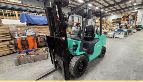
Chariot élévateur Mitsubishi Caterpillar FG 30 N, propane, pneumatique, side shift, 20442 H.
