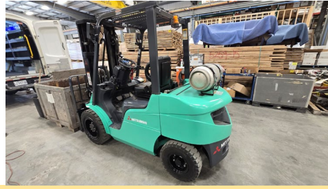
Chariot élévateur Mitsubishi Caterpillar FG 30 N, propane, pneumatique, side shift, 20442 H.
