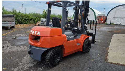
Chariot élévateur Toyota diésel 7FDU35, cap. 7300 LB, 3 mâts, élévation 179", 12860 H.
