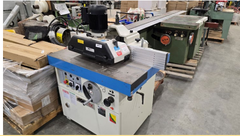
Toupie à table coulissante Holytek, mod. HC-512MSL, 2019, cap. 7.5 HP avec alimentateur Holytek
