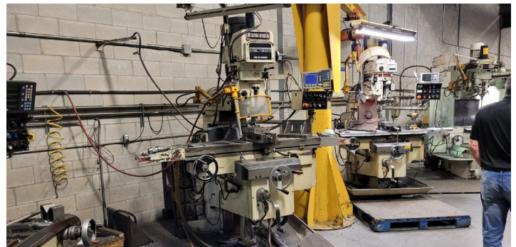
Fraiseuse Eumega, MDV6SR1, 2003 avec contrôle Acu-Rite
