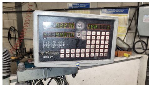
Tour Protturn, mod. S1760, avec contrôle numérique Borshan, SD56-2V
