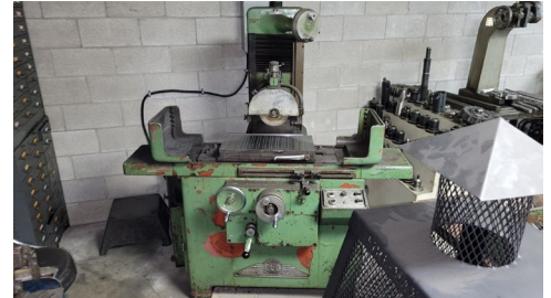
Surface grinder ELB, avec table magnétique
