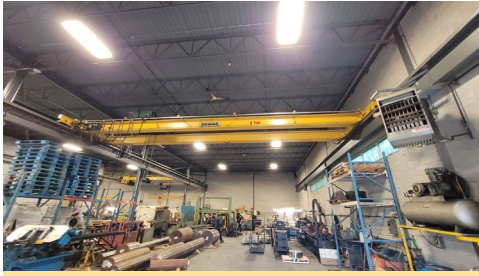
Pont roulant double poutre Demag, avec télécommande 38', cap. 7 tonnes, avec « buzz bar »
