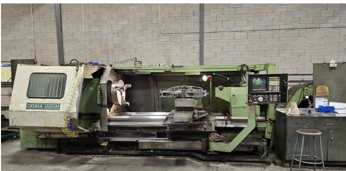
Tour CNC Okuma, mod. LH55N avec contrôle Okuma OSP5020L, tourelle 6 outils et convoyeur à copeaux Enmoto, mod. EA-30350-H, 1991
