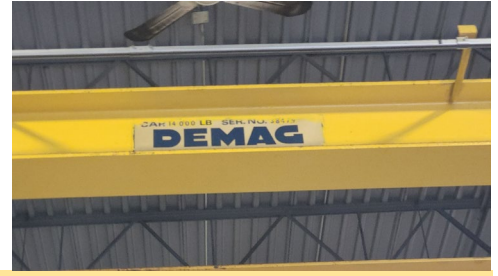
Pont roulant double poutre Demag, avec télécommande 38', cap. 7 tonnes, avec « buzz bar »
