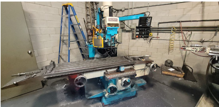
Fraiseuse Maximart, MXD5S, 2002, avec contrôle numérique Fagor
