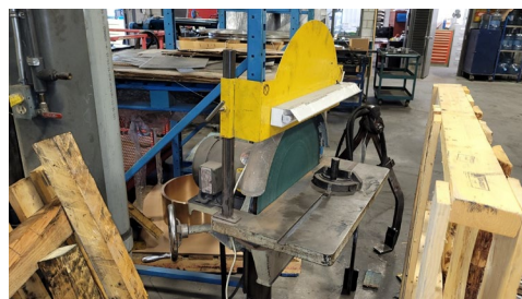
Sableuse latérale, moteur Baldor
