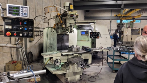
Fraiseuse Manford, mod. MF-E185VS-SP, 2012, 220 volts, avec contrôle Acu-Rite
