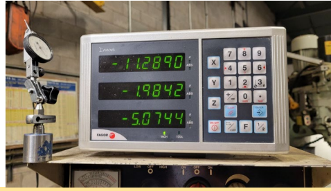
Fraiseuse Eumega, MDV6SR1, 2003, avec contrôle numérique Fagor
