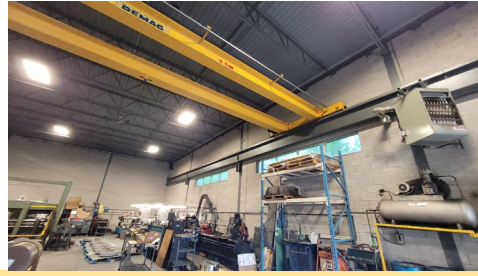
Pont roulant double poutre Demag, avec télécommande 38', cap. 7 tonnes, avec « buzz bar »
