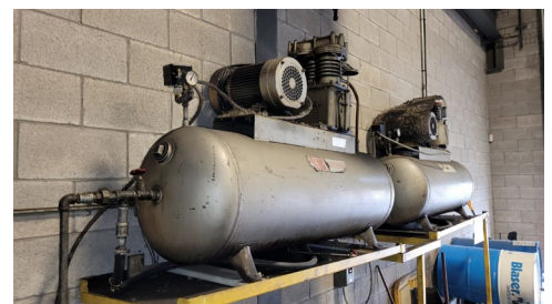
2 X Compresseurs à piston Air-Tek, 5 hp
