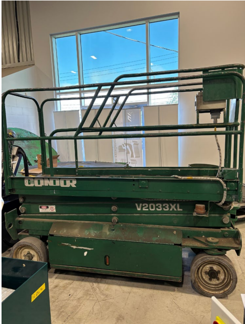
Nacelle électrique Condor, mod. 2033L, cap. 20' haut, 750 lb, chargeur 110 volts
